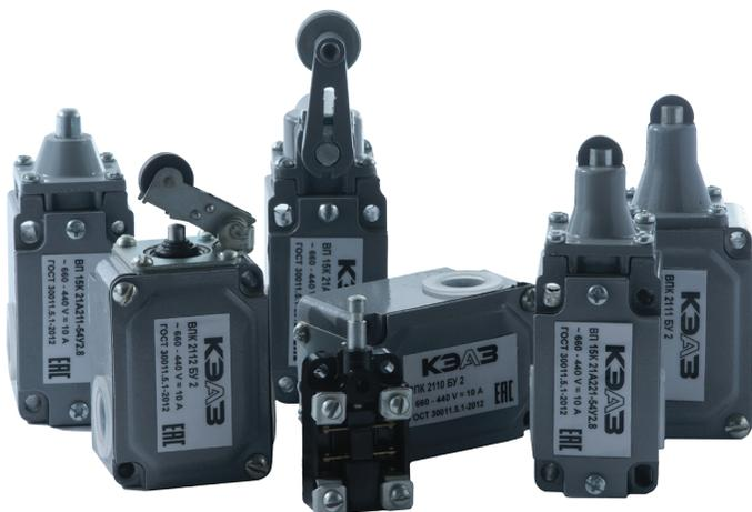
Выключатели путевые предназначены для коммутации электрических цепей управления переменного тока напряжением до 660 В частотой 50 Гц и постоянного тока напряжением до 440 В под воздействием управляющих упоров в определённых точках пути контролируемого объекта.
